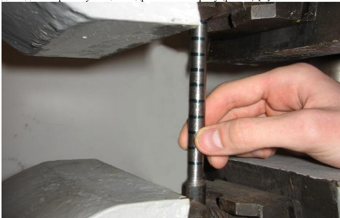
Рис. 2 Встановлення дослідного зразка у лещата гідравлічного пресу
